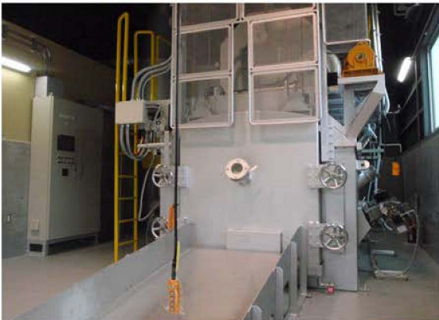
低くて緩やかなスロープで安全作業 広い開口部(1200W x 1150H) 床面から開口部までの高さ30cm
