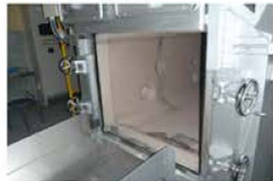
低くて緩やかなスロープで安全作業 広い開口部(1200W x 1150H) 床面から開口部までの高さ30cm
