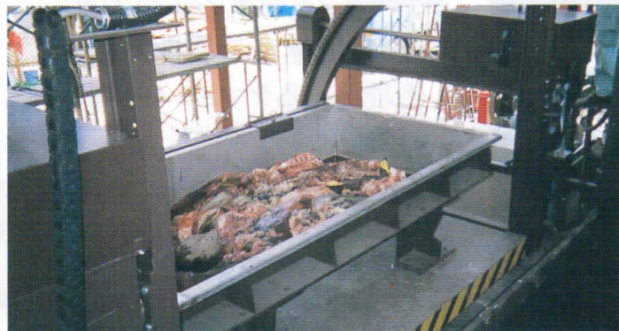
リフト&反転機でそのままに炉に投入
