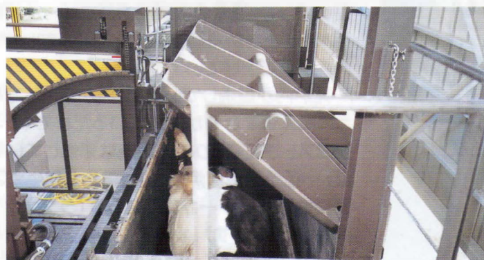
投入扉を閉め焼却開始
